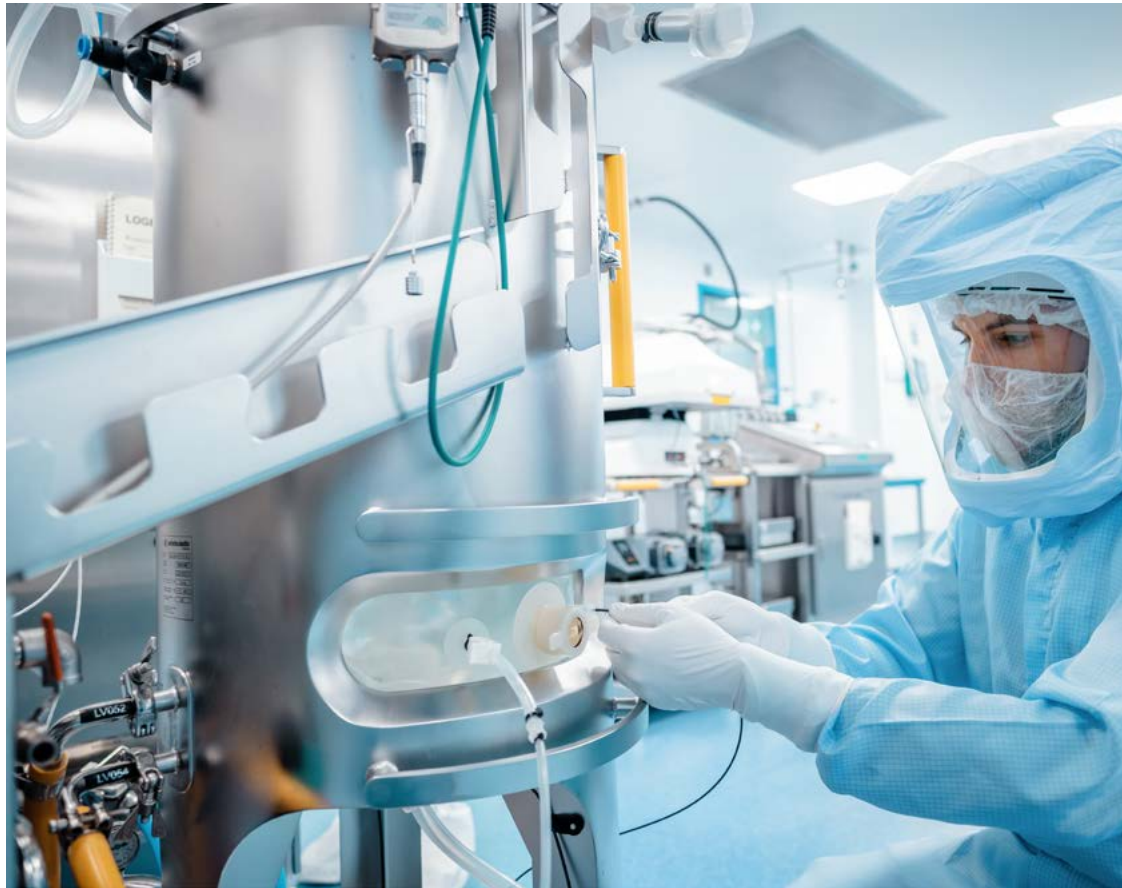
mRNA-Herstellung in einem 50-Liter-Bioreaktor: ca. 8 Millionen Dosen Impfstoff können so pro Umlauf hergestellt werden
