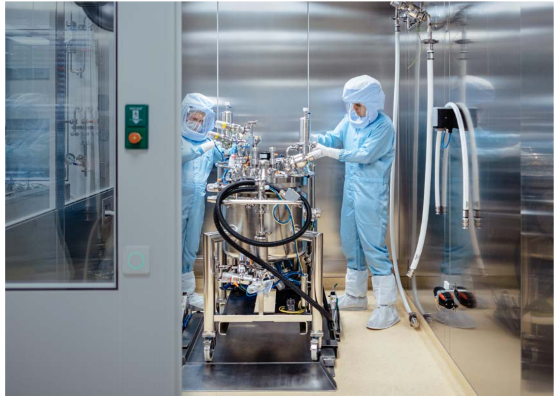
Formulierung des medizinischen Wirkstoffes in einem Lipid-Ethanol-Behälter: Kombination von mRNA und Lipiden
